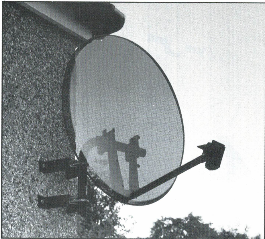
Ronde schotel van Marconi met offset feedhorn
